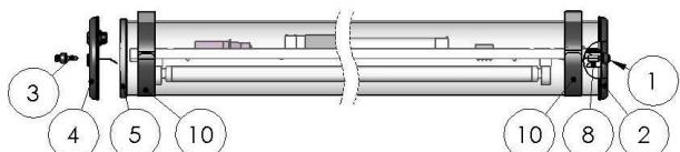
1.3 Montieren Sie die Leuchte in die Befestigungsklemmen ⑩, nachdem Sie diese wie in § 1.1 beschrieben, befestigt haben.
